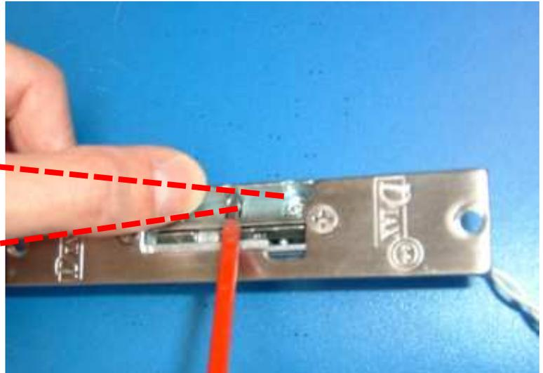
SE QUESTO PIOLINO SI MANTIENE PREMUTO LA SERRATURA SI SBLOCCA ANCHE SE FINISCE L'IMPULSO
